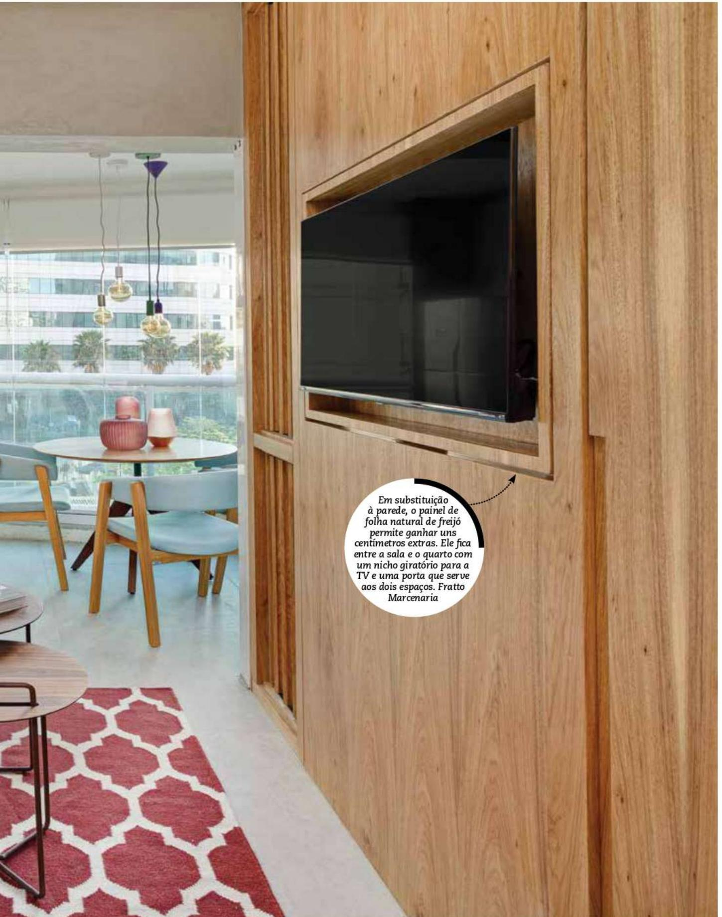
Em substituição à parede, o painel de folha natural de freijó permite ganhar uns centímetros extras. Ele fica entre a sala e o quarto com um nicho giratório para a TV e uma porta que serve aos dois espaços. Fratto Marcenaria
