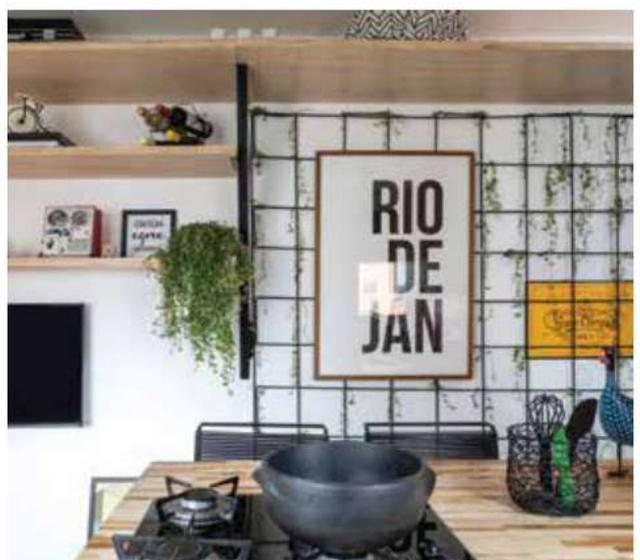
A base da bancada é um armário em compensado sobre o piso de cimento queimado todo impermeabilizado, assim como a prancha de madeira Teca natural, que ultrapassa a base em 25 cm para que as pessoas possam se sentar confortavelmente
