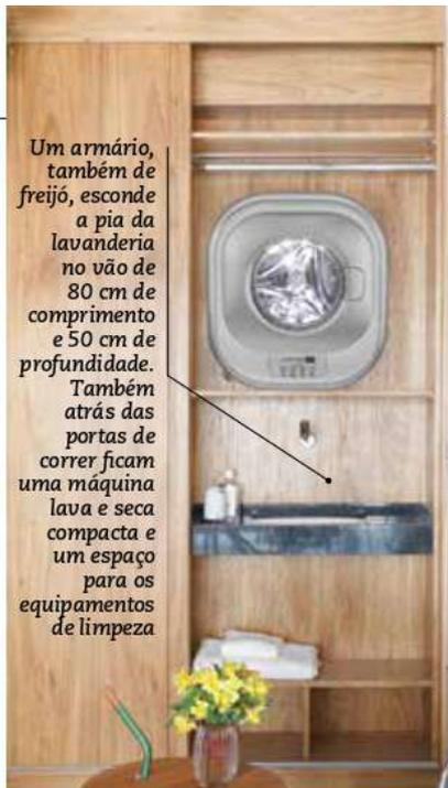
Um armário, também de freijó, esconde a pia da lavanderia no vão de 80 cm de comprimento e 50 cm de profundidade. Também atrás das portas de correr ficam uma máquina lava e seca compacta e um espaço para os equipamentos de limpeza
