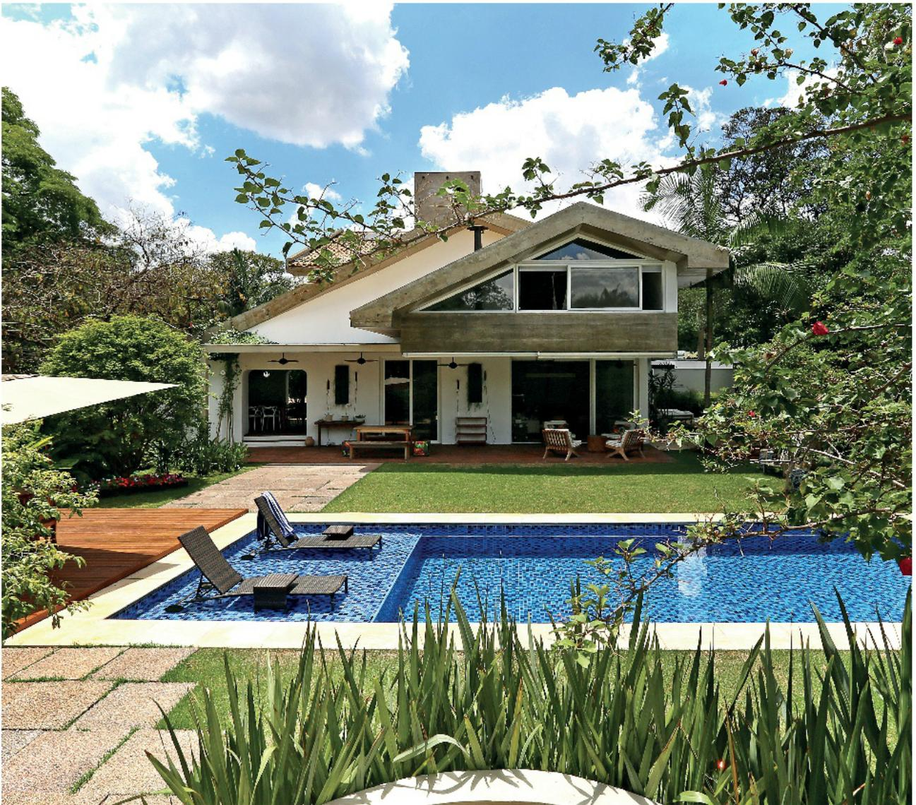
A fachada da piscina manteve o concreto aparente da arquitetura original que estrutura os telhados sobrepostos em duas águas. As novas esquadrias de PVC criaram vão maiores para integrar o jardim aos espaços internos
