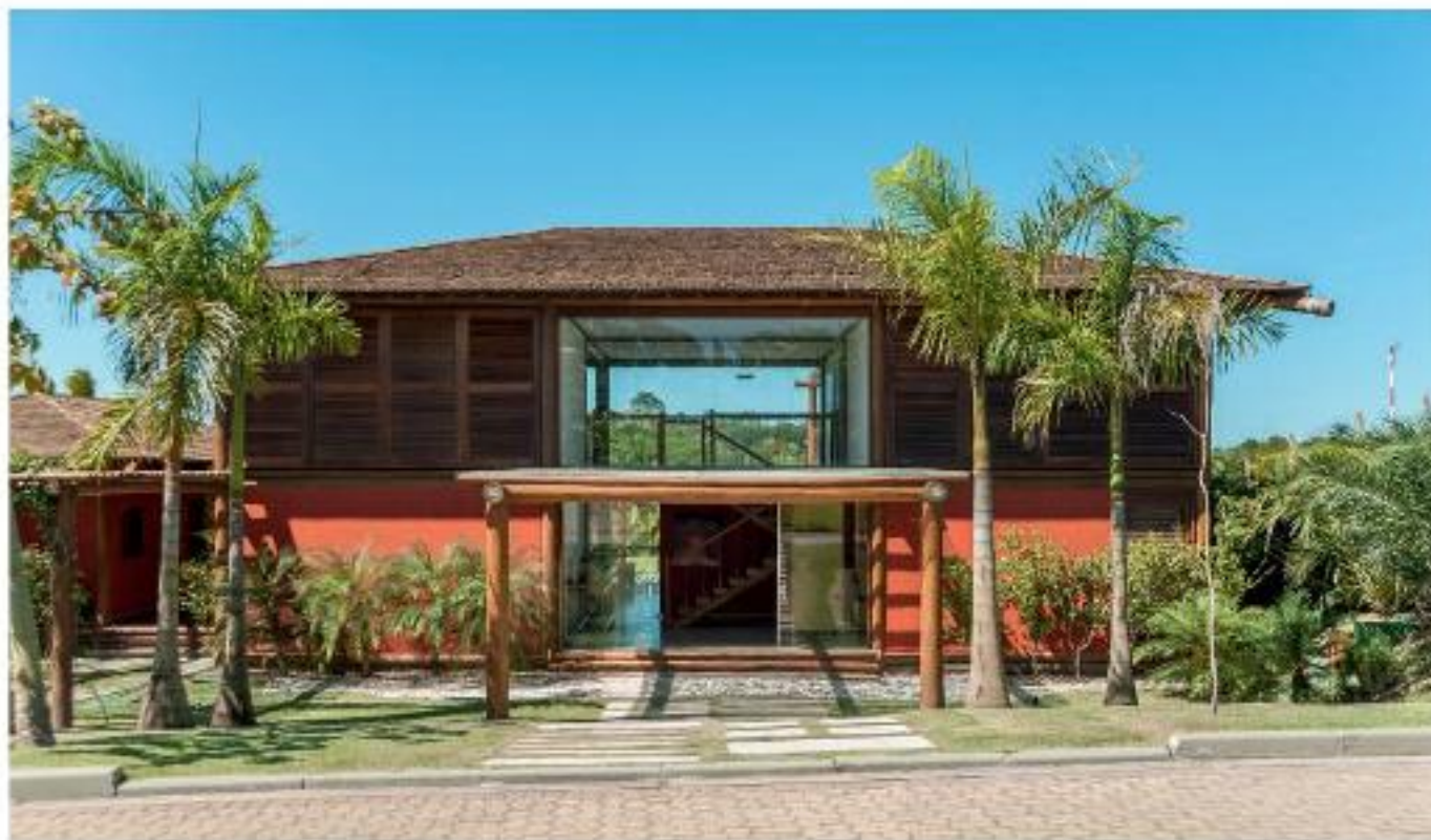
A residência está apenas 20% apoiada sobre o solo para não prejudicar a permeabilidade do terreno. Daí a presença abundante de decks e varandas
