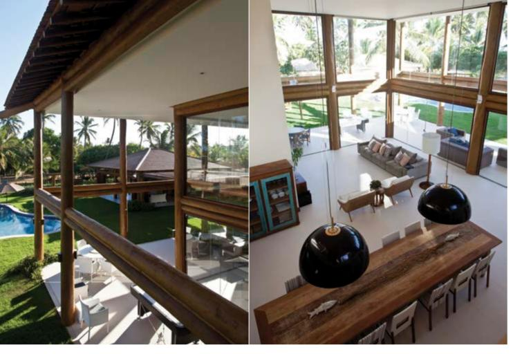
Suportado pelas colunas de eucalipto, o telhado se estende para além da construção central, formando a cobertura da varanda, que ganhou assim um pé-direito de 6m de altura. A solução possibilita o sombreamento e permite a ventilação natural de toda a casa. Na sala de jantar de 100m², pendentes da Omni Light iluminam a mesa de madeira de lei. Sobre os aparadores de madeira de demolição, fotos dos arredores. Cabos de aço inox e eucalipto formam o guarda-corpo.
